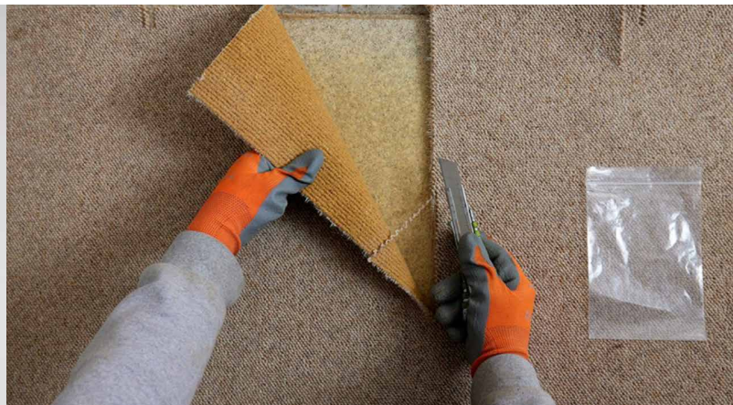
Prelievo di un campione da un rivestimento per pavimenti multistrato in materiale sintetico (ad es. sotto moquette): in caso di rivestimenti multistrato, occorre prelevare un campione che contenga tutti gli strati, colla compresa.
